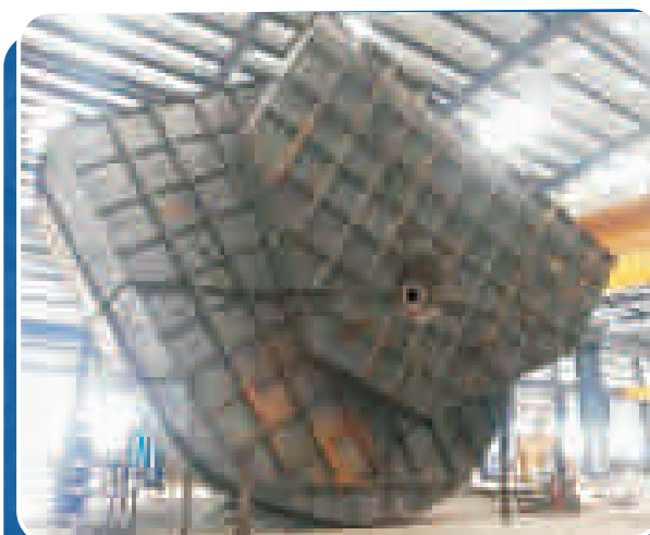
Spiral Fan Casing Assembly
